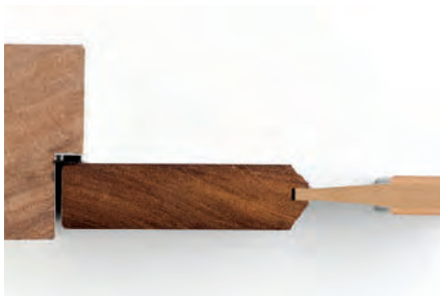
Doorsnede standaard deur
